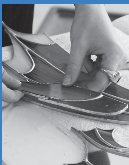
Pratique en atelier, 2025, assemblage des pièces en verre et préparation pour la soudure à l'étain © Alexandre Beltran
