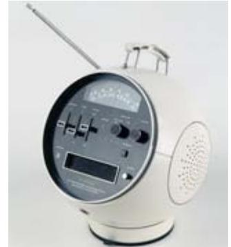
**ANONYME** - Radio Prinz sound/Weltron 1970 - Acrylonitrile butadiène styrène et polyméthacrylate de méthyle - Inv. : 97.17.1
